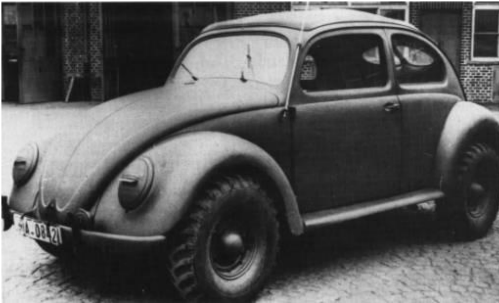
Der Kommandeurwagen bestand im Prinzip aus der Karosserie des KdF-Wagens und dem Fahrwerk des Schwimmwagens.
