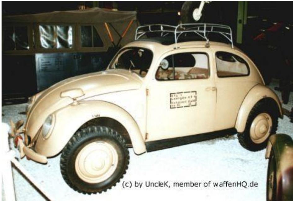
Der VW Typ 82 E mit dem geländegängigen Fahrwerk des Kübelwagens
